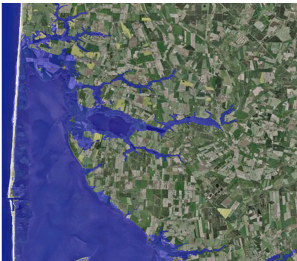
Figur 2.9 Område ved Nissum Fjord, som kan blive oversvømmet af fremtidens 100 års hændelse, hvor vandstanden forventes at nå kote 1,6 meter
